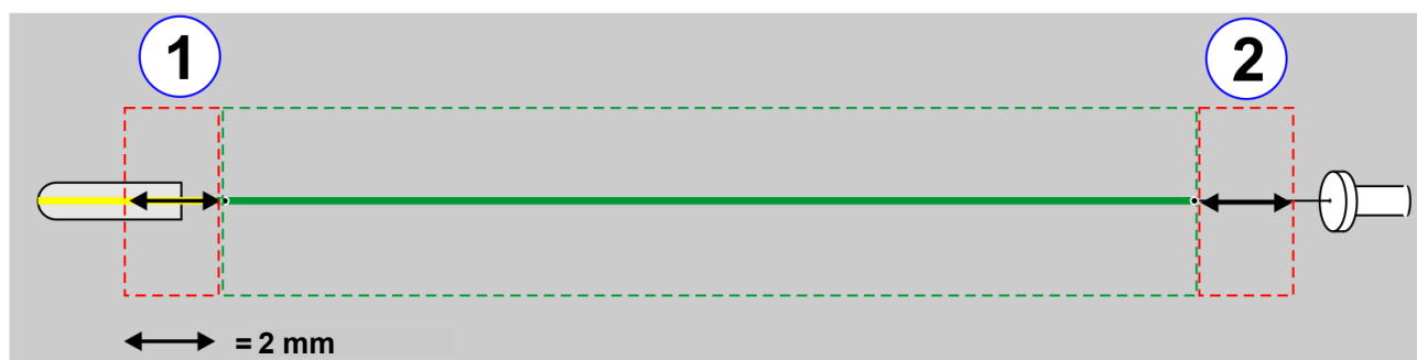
Slika 2. Margine oko rekonstruiranog katetera. Zelena isprekidana linija označava marginu od 2 mm oko katetera. Pogrešne margine prikazuju se kao crvene isprekidane linije na kraju vrha (1) i na kraju priključka (2).
