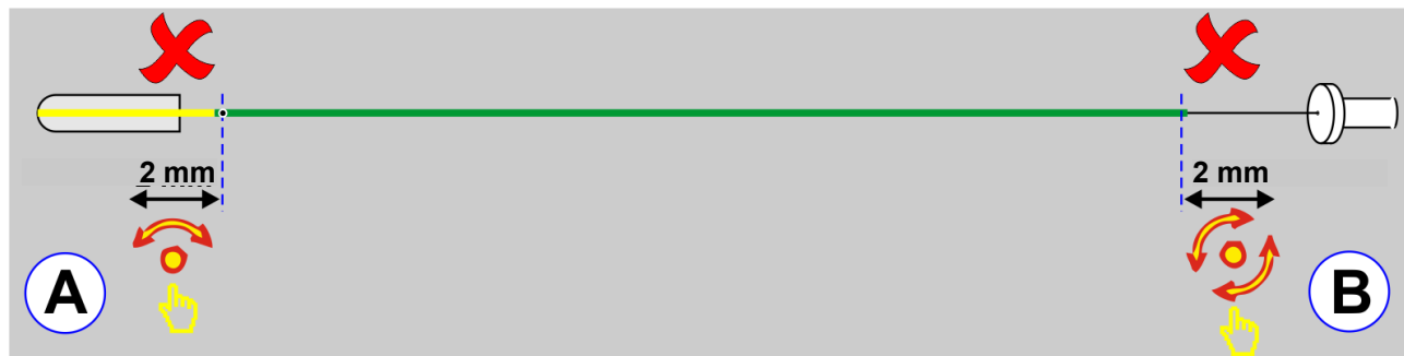
Slika 3. Scenariji A i B u kojima upotreba funkcije savijanja katetera može dovesti do uvođenja pogreške rekonstrukcije.
