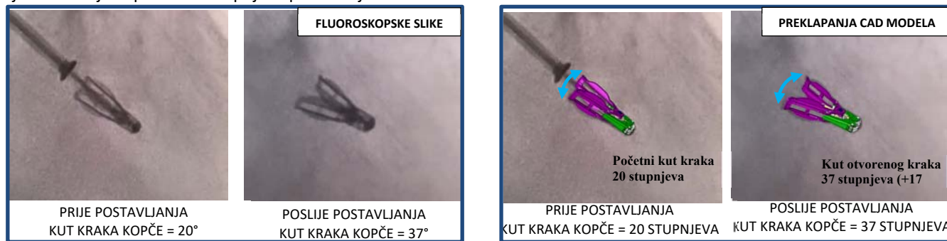
Slika 1: Fluoroskopska slika otvaranja kopče dok je zaključana (COWL) pri postavljanju (lijevo) s nametnutim slojem CAD modela (desno)
