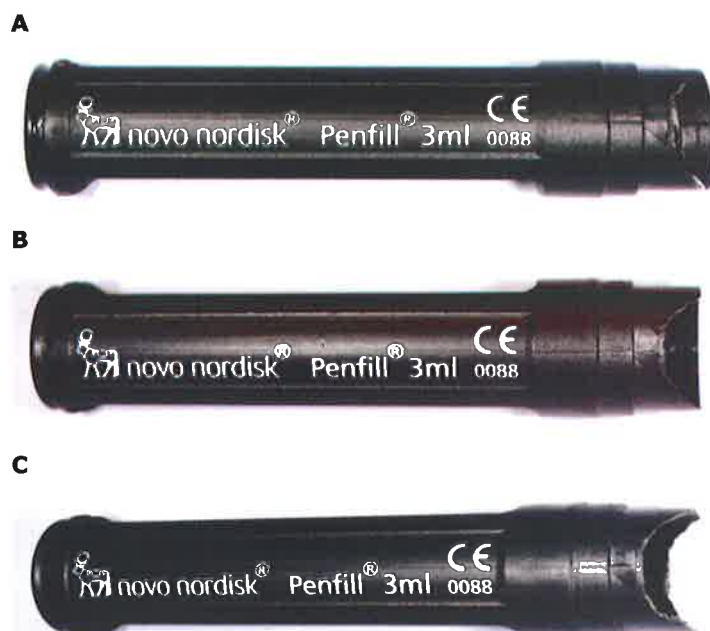
Slika 1. Mogu se pojaviti tri vrste neispravnosti: 1) Napuknuće pričvrsnice, 2) Jedna pričvrsnica odlomljena i 3) Obje pričvrsnice odlomljene.
