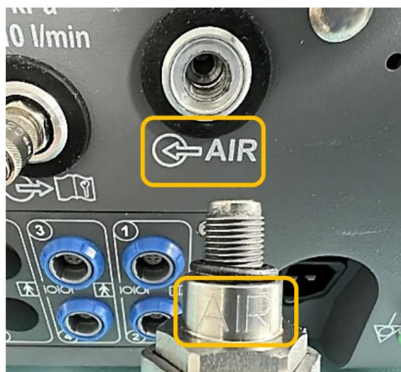
Slika 3: NIST kodiranje konektora
