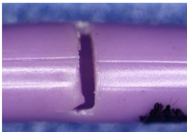
Slika 1: primjer poprečne/obodne pukotine u tijelu katetera
