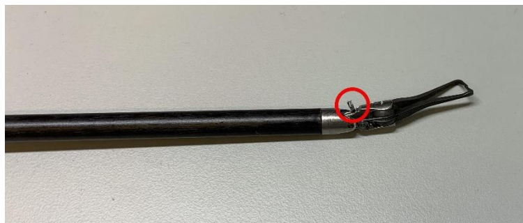
Slika F: Slomljeni kabel za nagib
