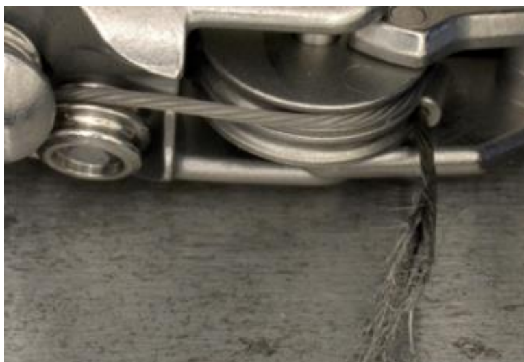
Slika C: 20x povećanje slomljenog kabela na instrumentu da Vinci Xi.
