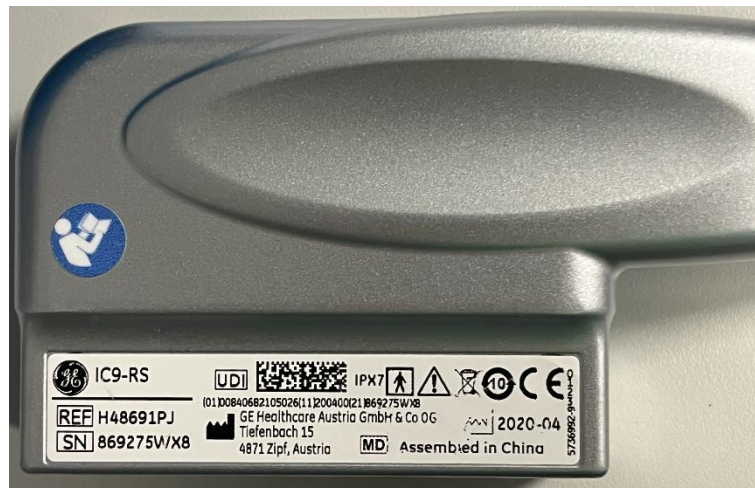
Slika 4. Primjer natpisne pločice – prikazani su vrsta sonde (IC9-RS) i serijski broj (SN).
