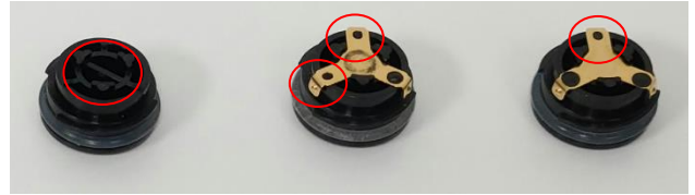
Oštećeni poklopci baterije - nemojte koristiti! Metalni kontakt nedostaje ili su manje od 3 točke odignute
